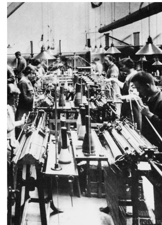
Produktion von Strickwaren auf Hand-Flachstrickmaschinen © Falke KGaA
